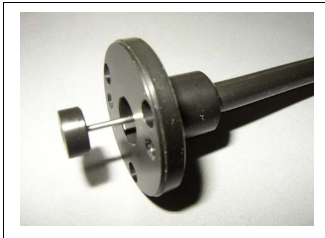
插图 84 伸出吸枪探尖法兰的钢毛细管
