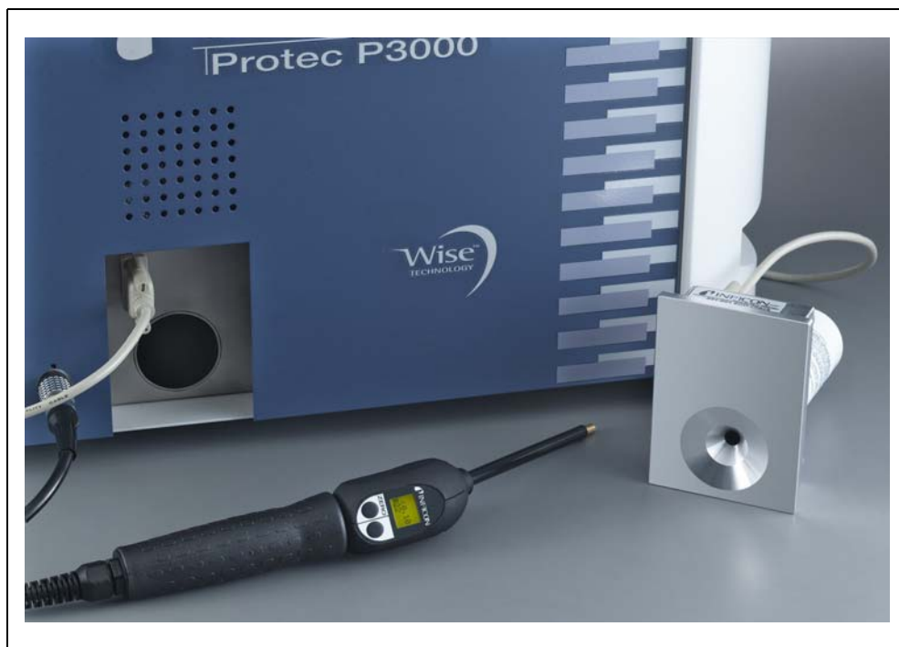
插图 15 从主机上拆下的 PRO-Check 参考漏孔，可供以后使用
