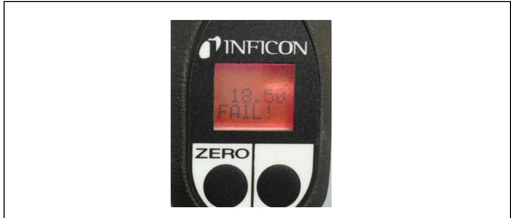
插图 22 检测到泄漏时的吸枪显示器
