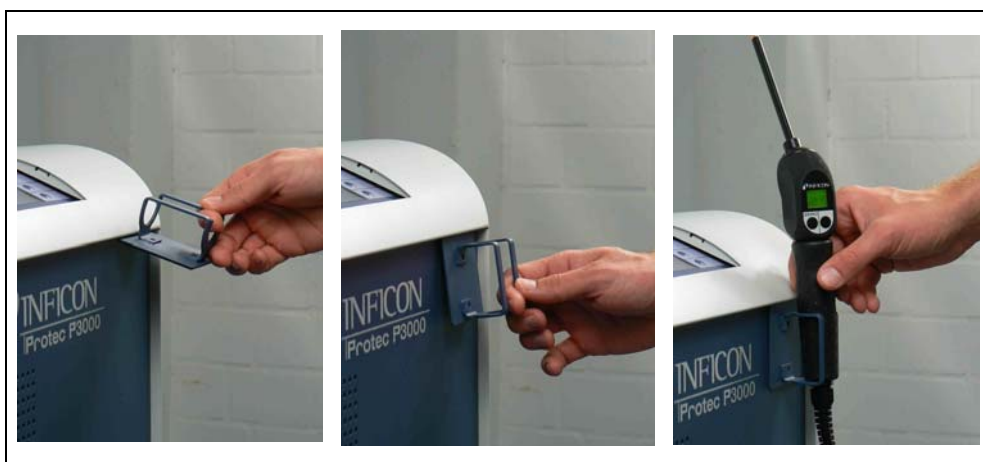
插图 8 安装吸枪管线支架
