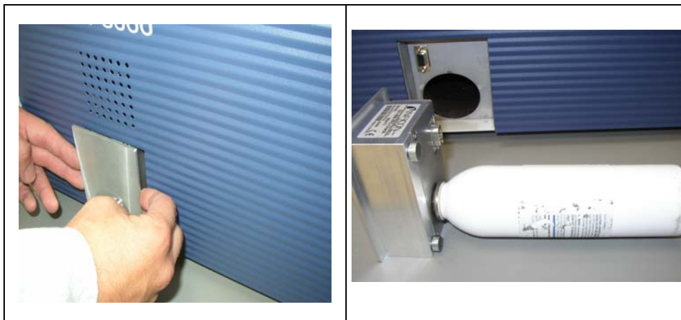
插图 85 从主机上拆下 PRO-Check 参考漏孔
