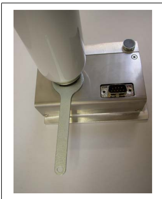
插图 87 安装气体贮存器
