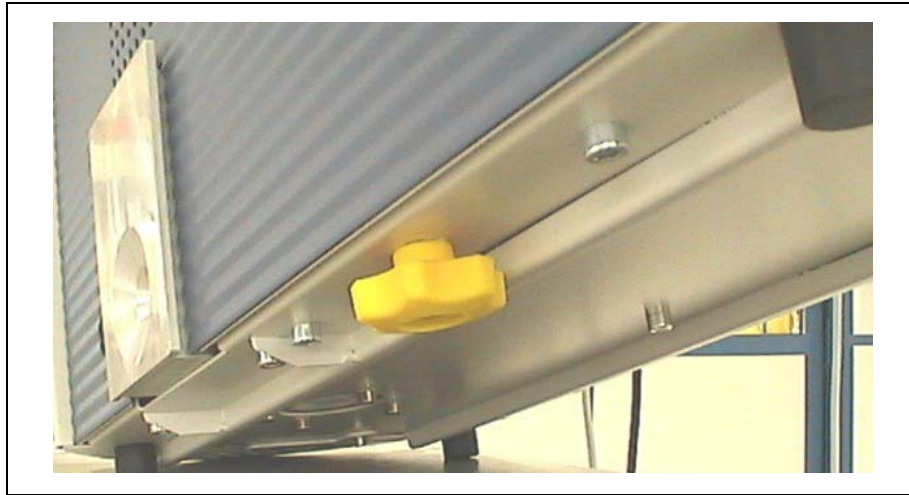
插图 3 启动前拆下运输锁
