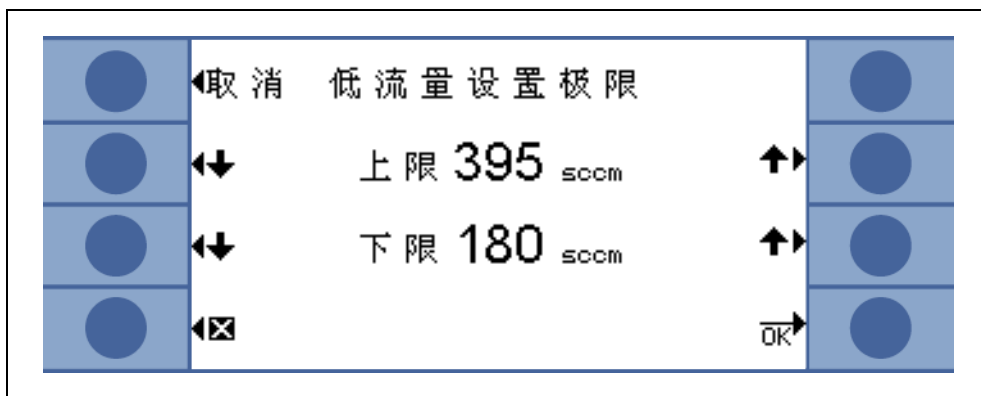
插图 49 改变 SL3000 吸枪管线的流量限值
