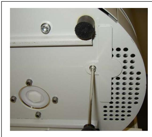
Fig. 69 El sujetador del filtro de aire está en la parte inferior del detector de fugas
