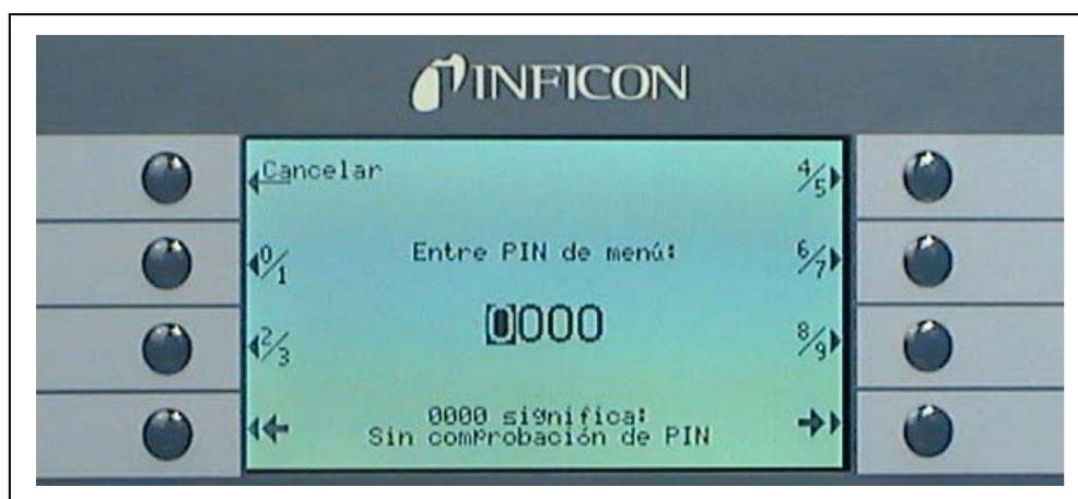
Fig. 53 Configurando un PIN de menú para proteger los parámetros
