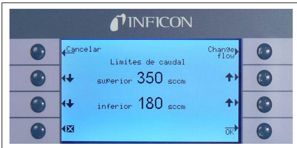
Fig. 49 Cambiando los límites de flujo del conducto de sorbedor SL3000.
