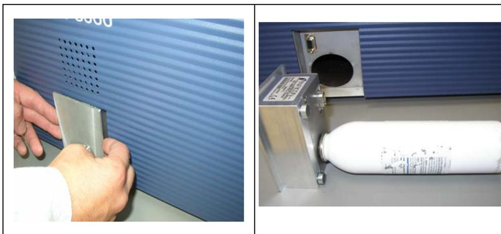
Fig. 85 Extrayendo la fuga de referencia PRO-Check de la unidad principal.
