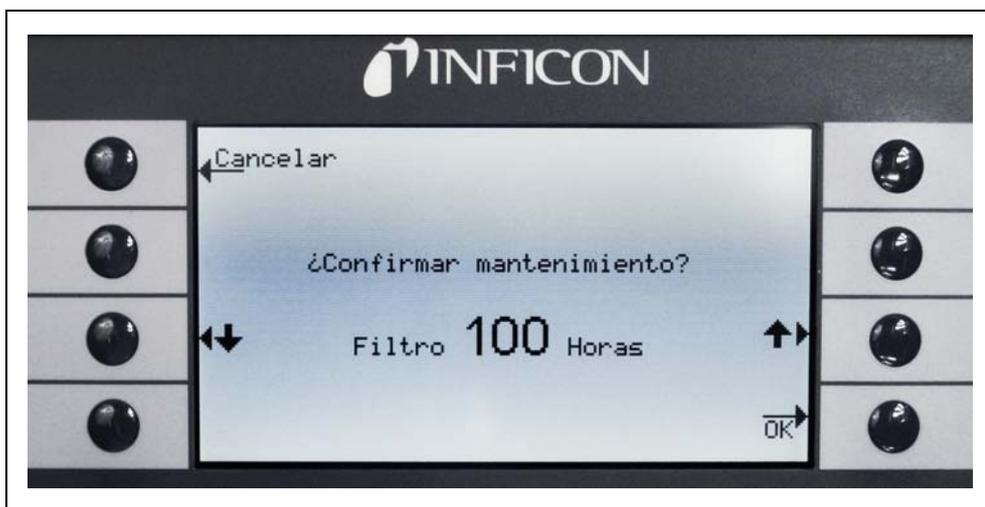
Fig. 61 Configurando el intervalo de mantenimiento para el filtro de la punta del sorbedor y confirmando su recambio
