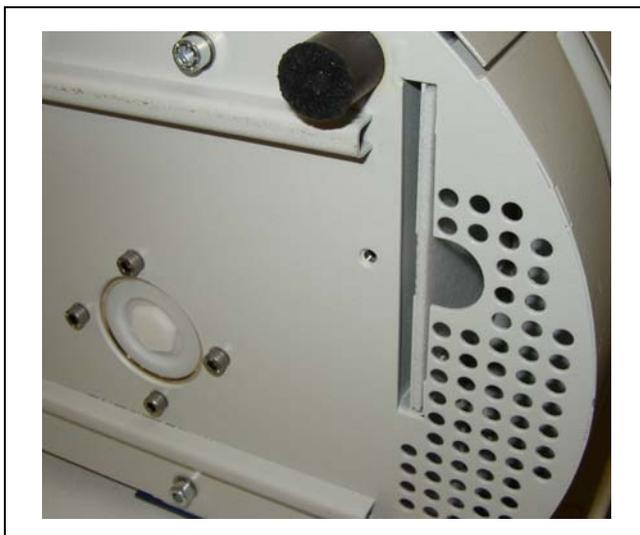
Fig. 70 Desmontaje del filtro de aire
