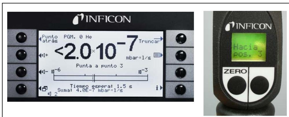
Fig. 26 Pantalla del programa I•Guide solicitando el próximo punto
