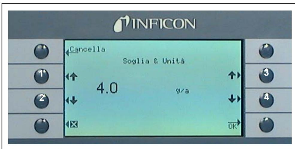
Fig. 46 Ajustando el nivel de disparo y la unidad de medición
