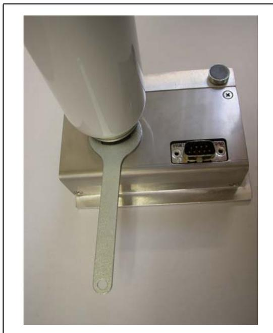
Fig. 87 Instalación del depósito de gas
