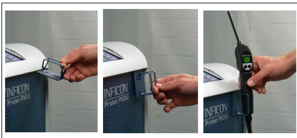
Fig. 8 Instalación del soporte del conducto del sorbedor
