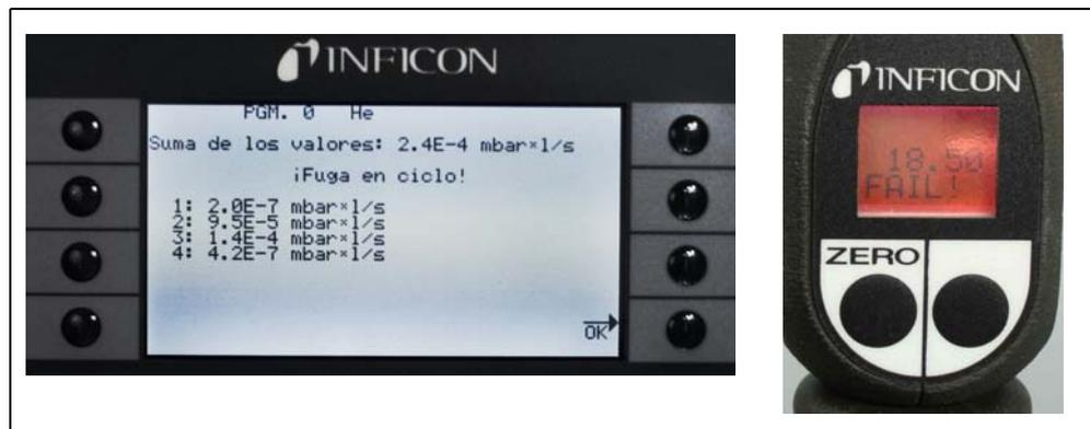
Fig. 28 Resultado del programa I•Guide: unidad bajo prueba rechazada
