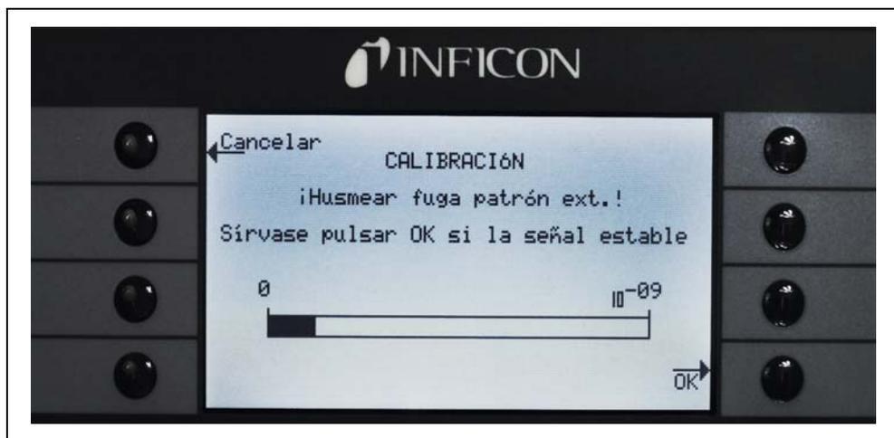
Fig. 35 Pantalla de calibración durante la calibración externa
