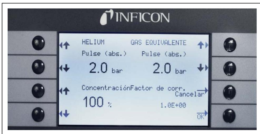
Fig. 45 Editando parámetros para las tasas de fugas del refrigerante equivalente
