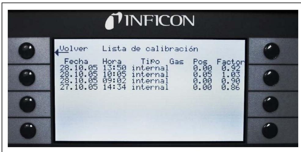
Fig. 60 Ejemplo de un historial de calibración del Protec P3000
