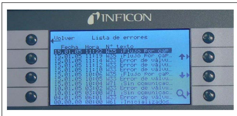
Fig. 59 Ejemplo de una lista de errores del Protec P3000
