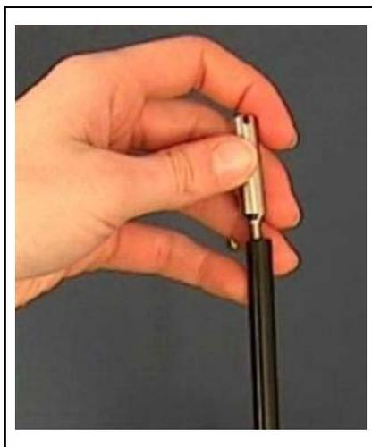
Fig. 4 Instalando la punta de protección contra el agua
