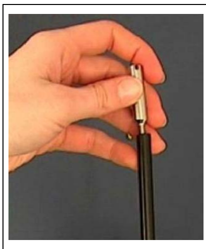
Fig. 4 Installation de l'embout de protection contre l'eau
