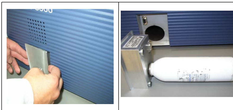
Fig. 84 Retrait de la fuite de référence PRO-Check de l'avant de l'unité principale
