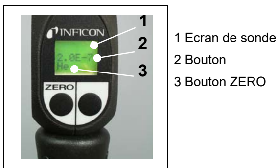
Fig. 12 Conduite de reniflage avec sonde de reniflage SL3000(XL)
