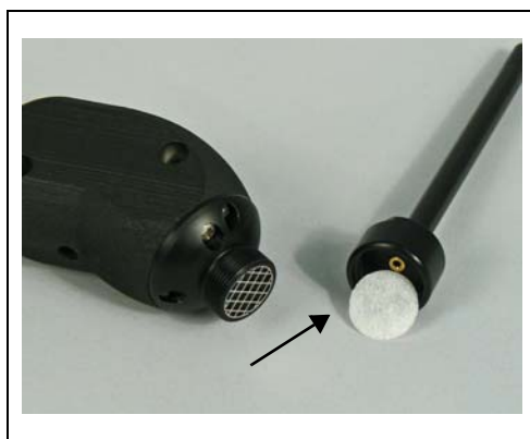
Fig. 78 Tampon filtrant retiré
