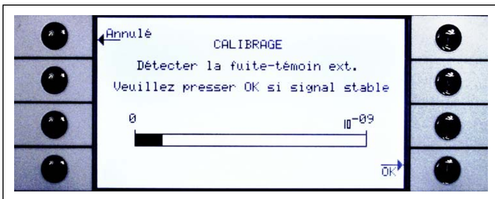
Fig. 35 Ecran de calibrage pendant le calibrage externe
