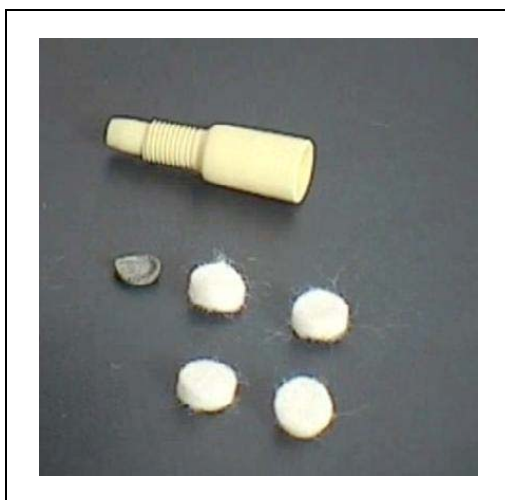
Fig. 74 filtres en feutre neufs et utilisés
