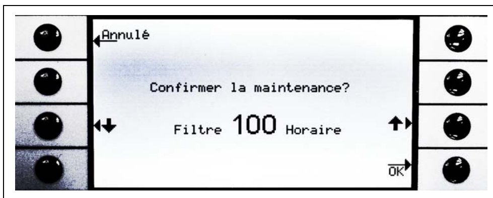
Fig. 60 Réglage de l'intervalle de maintenance pour le filtre de l'embout de reniflard et confirmation de son remplacement
