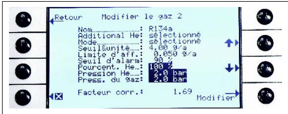
Fig. 43 Réglage d'un facteur de correction de réfrigérant équivalent
