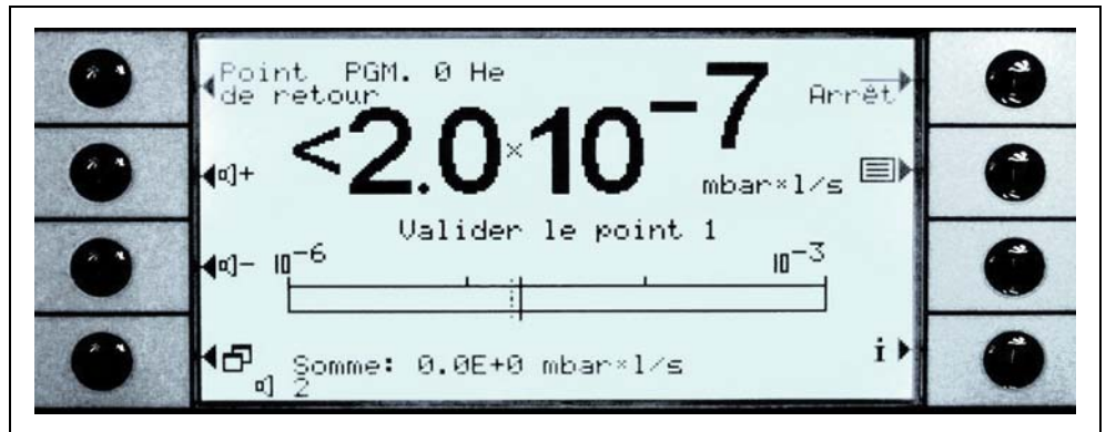
Fig. 23 Ecran de mesure en mode I•Guide
