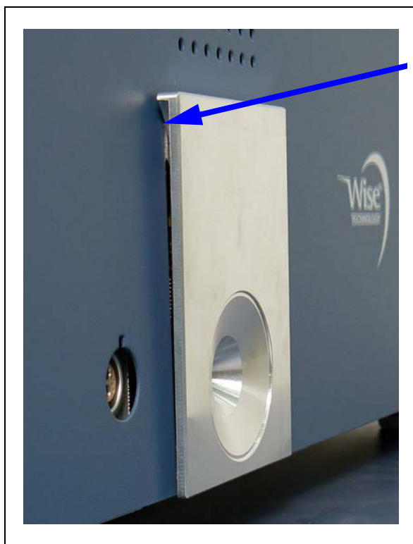
Fig. 87 Espace entre le PRO-Check et le panneau frontal
