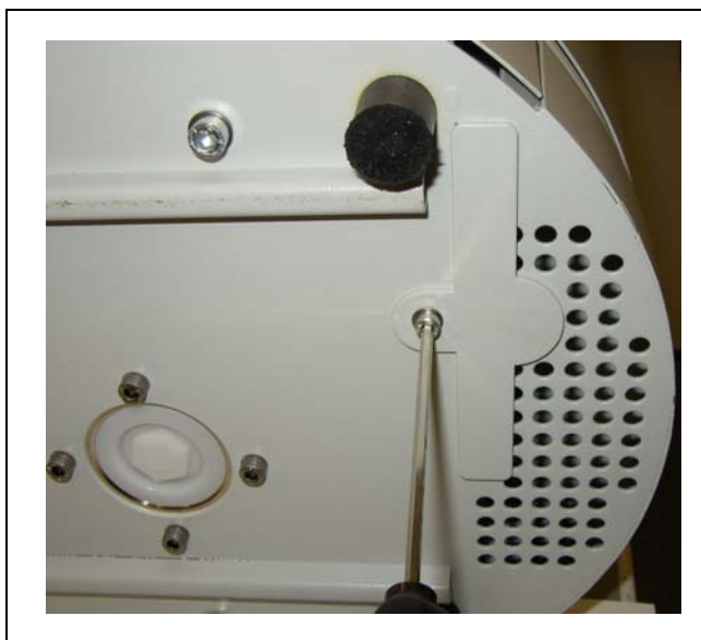
Fig. 68 Le support pour le filtre à air se trouve sur le fond du détecteur de fuite
