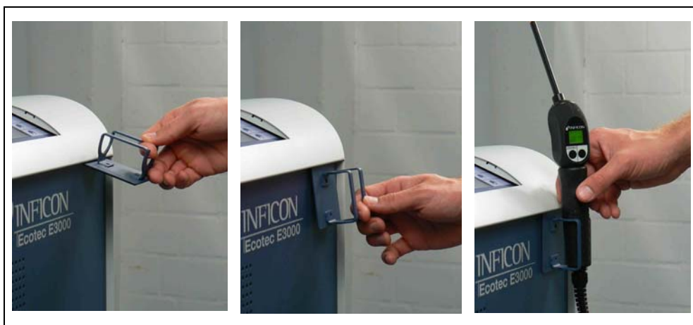
Fig. 8 Installation du support de conduite de reniflage
