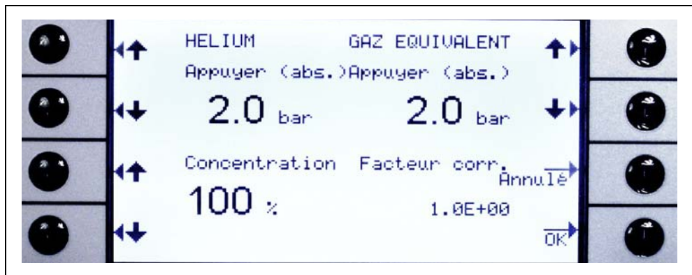
Fig. 44 Edition des paramètres du taux du fuite de réfrigérant équivalent
