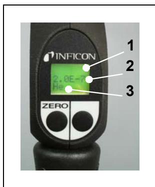
Fig. 20 Ecran de reniflard en mode de fonctionnement standard
