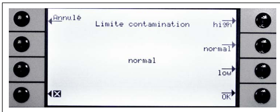
Fig. 47 Réglage de la limite de contamination
