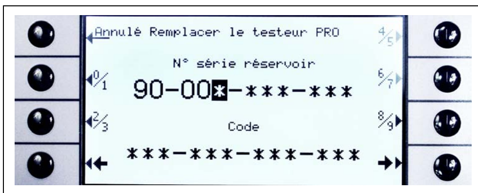
Fig. 88 Ecran de saisie pour le remplacement de la fuite PRO-Check
