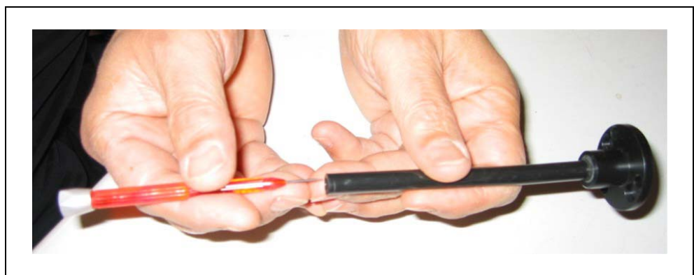
Fig. 82 Extraction du capillaire d'acier
