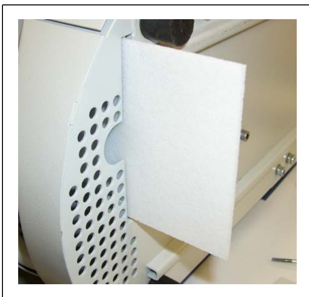
Fig. 70 Insertion du filtre à air
