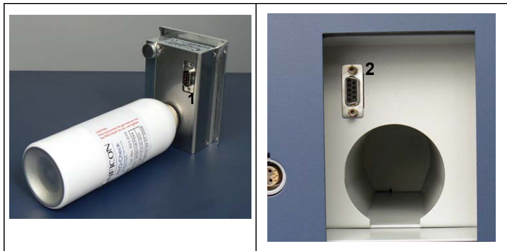
Fig. 16 Raccordements pour l'utilisation à distance
