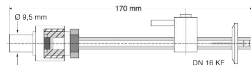
Kalibrierleck mit Stiftgehäuse und VCO-Anschluss
