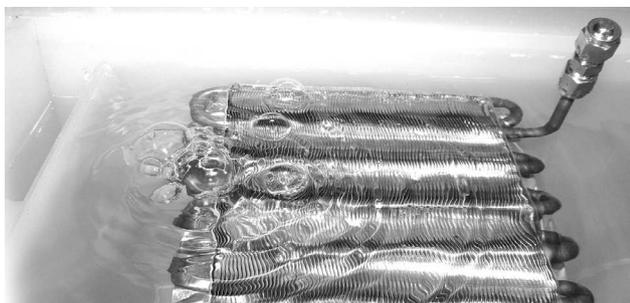
Bei einer Leckrate von 0,06 sccm entsteht unter idealen Bedingungen – die in der Praxis selten erreichbar sind – eine Blase pro Sekunde. Jedoch dauert es bei einer Leckrate von 0,006 sccm schon 30 Sekunden, bis sich eine einzelne, kleine Blase bildet.
